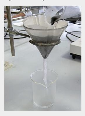
(Desechando el residuo sólido, compuesto por el carbón activo y las impurezas insolubles, que aparece en el filtro de pliegues).
