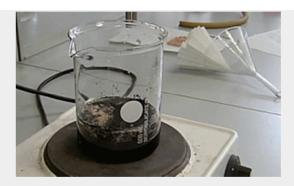
4) Filtrar la solución en caliente con un embudo cónico y filtro de pliegues para eliminar las impurezas insolubles y el carbón activo
