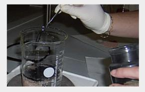
3) Calentar hasta ebullición la mezcla comprobando que se ha disuelto completamente el producto a recristalizar.
