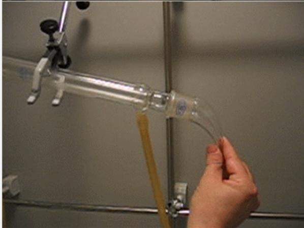
Se monta la cola de destilación junto con un recipiente (Erlenmeyer o vaso de precipitados) donde se recogerá el destilado.
