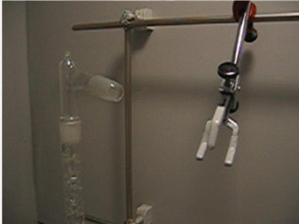
Posteriormente colocamos la cabeza de destilación sobre la columna Vigreux, y se ajusta una pinza horizontalmente para fijar el refrigerante recto.
