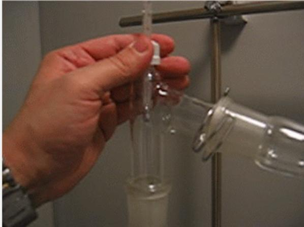
Seguidamente, se sitúa termómetro con su adaptador en la parte superior de la cabeza de destilación.
