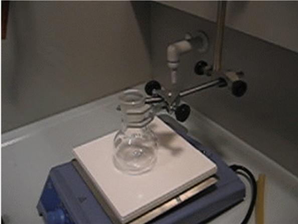
A continuación se coloca el matraz de fondo redondo sobre la placa calefactora y ajustado en su embocadura por la pinza.
