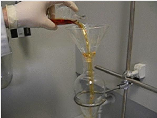
En primer lugar se vierte la disolución  $I_2/I^-$  acuosa en el embudo de decantación (usamos un embudo para evitar salpicaduras).
