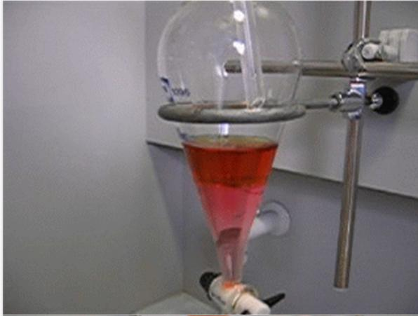
Se observan claramente dos capas con distintos colores. La fase orgánica, abajo, previamente incolora ( $\text{Cl}_2\text{CH}_2$ ) aparece ahora de color roja debido a la presencia de  $\text{I}_2$
