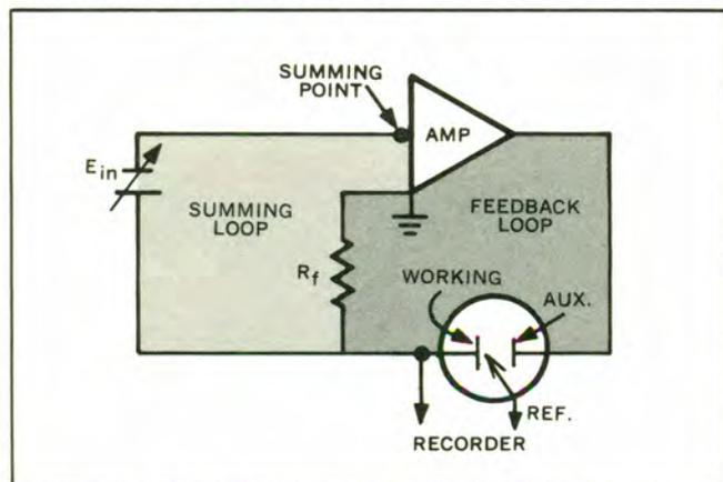
Figure 2. Galvanostat System.
